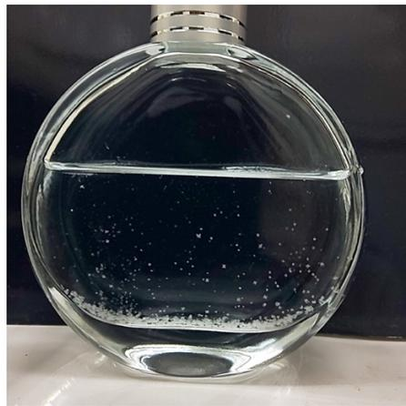
図. 2 作成直後の様子。液温が下がるにつれて、星状の結晶が析出してくる。
