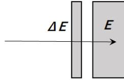
検出器が測定したエネルギーをそれぞれ  $\Delta E, E$  とするとき、 $\Delta E$  は  $\Delta E \cong \left| \frac{dE}{dx} \right| \Delta x$  と書け、エネルギー損失  $\frac{dE}{dx}$  は  $-\frac{dE}{dx} = \frac{z^2 e^4}{4\pi \epsilon_0^2 m v^2} \frac{Z}{A} \rho \ln \frac{2mv^2}{I}$  でよく近似できることが知られている。
