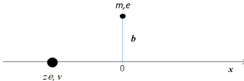
荷電粒子の通過により電子が受ける運動量の大きさ  $p$  は力積により計算できる。荷電粒子の軌道となる直線を  $x$  軸にとり、最近接の位置を原点として  $t = 0$  に通過したとする。電子と荷電粒子の最近接距離を  $b$  とする。対称性から荷電粒子の進行方向に垂直の成分  $F_{\perp}$  のみを考えればよいので、力積は  $p = \int_{-\infty}^{\infty} F_{\perp} dt$  で求められ、結果を  $m, z, v, b$  を用いて表すと  $p =$  (ii) となる。
