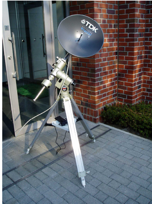
図4. 太陽を観測する電波望遠鏡。BS アンテナとアマチュア用天体望遠鏡の赤道儀で作った。
