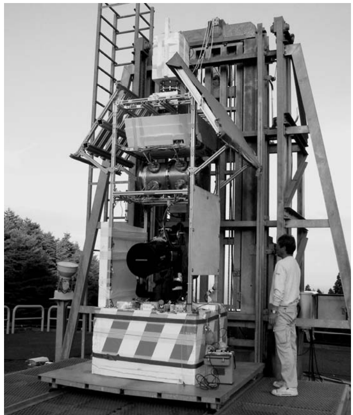
図4. 岩手県にある三陸大気観測所の放球装置上に設置され、最終噛合試験中の気球搭載望遠鏡。この写真が撮影された2007年の実験では残念ながら、外的な原因のために放球には至らなかった。2008年からは実験場所が北海道大樹町に移った。2008年も新実験場でのオペレーション習熟のため、我々の実験は実施されなかった。
