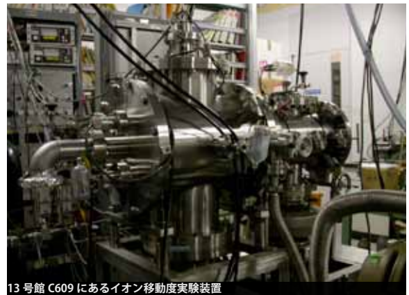
13号館C609にあるイオン移動度実験装置
