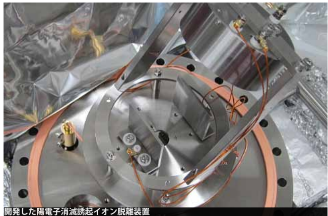
開発した陽電子消滅誘起イオン脱離装置
