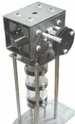
光電効果を用いた低エネルギー電子銃。光電陰極にLaB6単結晶、光源に半導体レーザーを用いることにより、エネルギー分析器を使わずに0.15eV程度のエネルギー分解能の実験が可能となる。
