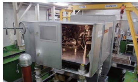
Cockcroft-Walton 型 荷電粒子加速装置 イオン源と高圧ターミナル
