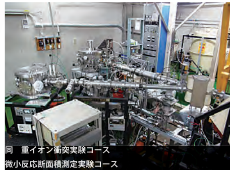
Cockcroft-Walton 型 荷電粒子加速装置 イオン源と高圧ターミナル
