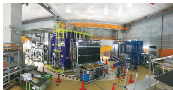
理化学研究所のSAMURAIスペクトロメータ。中央左側に見える濃い青のものがSAMURAI超伝導電磁石でその周辺のものほぼ全て反応生成物測定のための検出器である。
