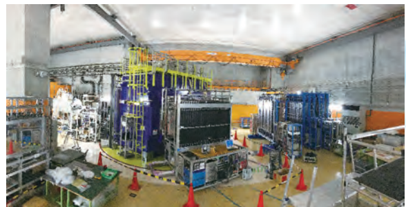
理化学研究所のSAMURAIスペクトロメータ。中央左側に見える濃い青のものがSAMURAI超伝導電磁石でその周辺のものはほぼ全て反応生成物測定のための検出器である。
